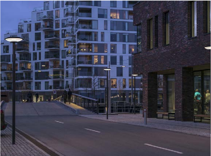
Eksempel på belysning ved veien i sentrumssonen, hvor lyset fordeles sirkulært, så det lander både på og ved siden av veien.
