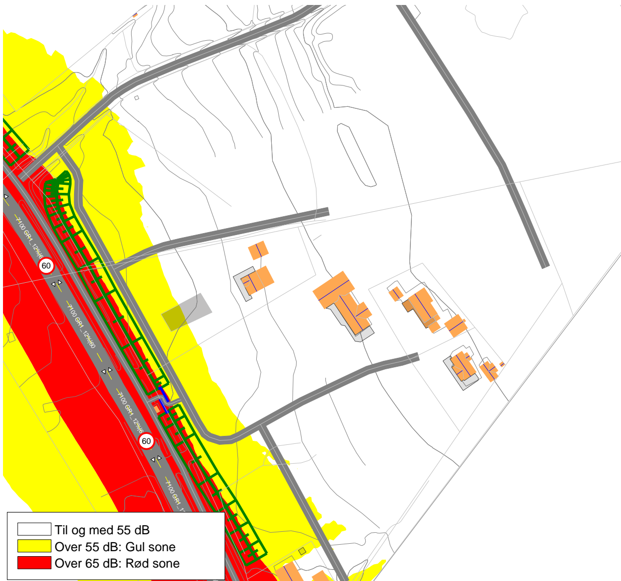
Figur 10: Støysoner, L_{den} (dB) i 4m høyde med støyvoll, markert med grønn strek. Gridopløsning 2x2 m.
