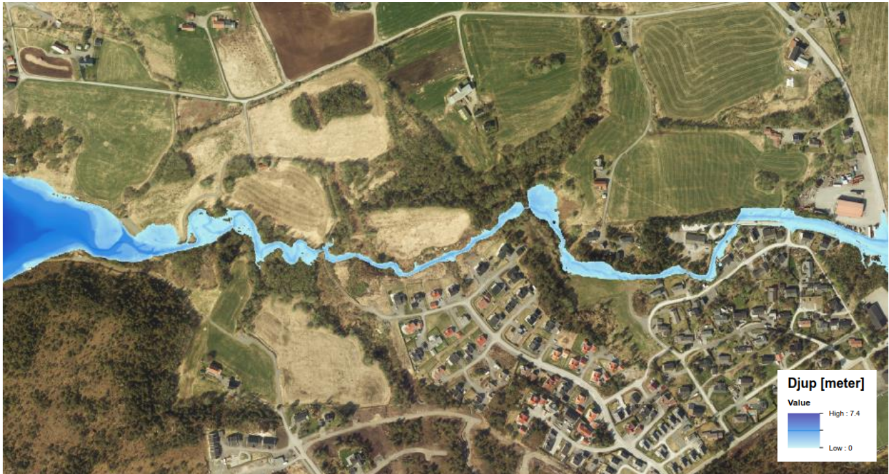
Figur 8. Modellert vanddybde for Q_{200} ved stabil modell.
