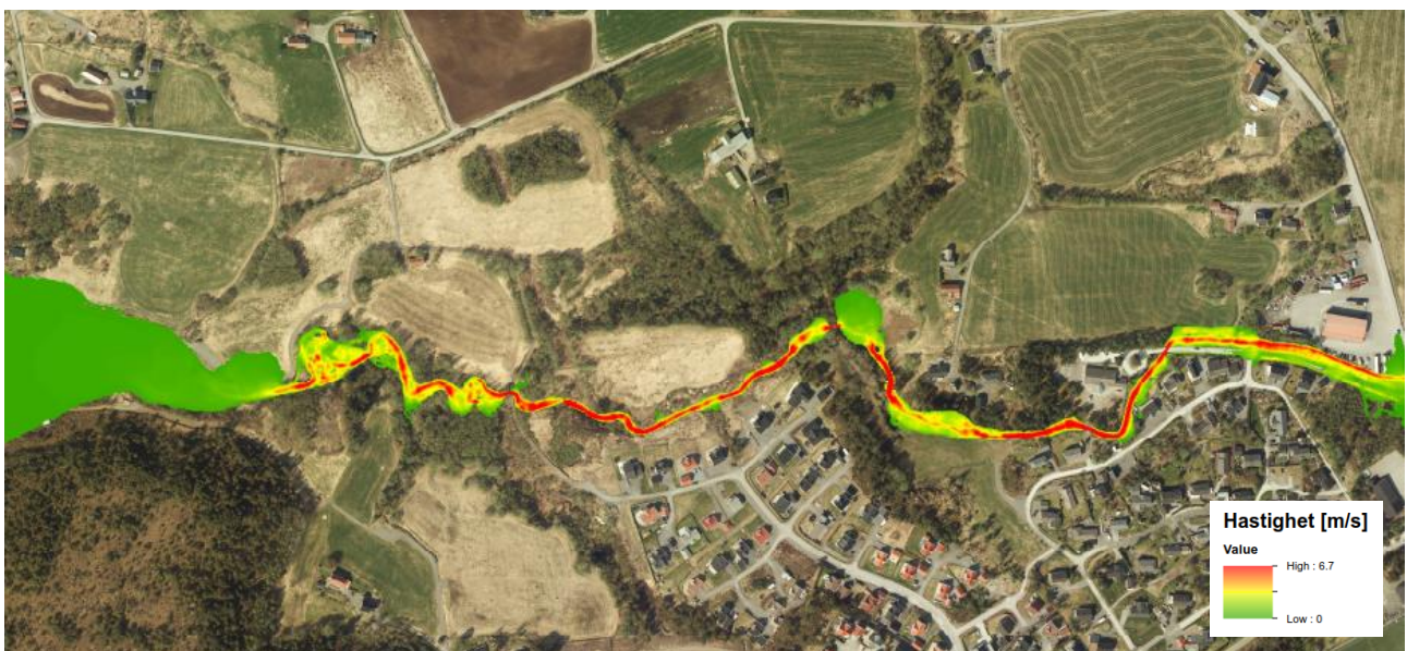
Figur 9. Modellert vannhastighet for Q_{200} ved stabil modell.
